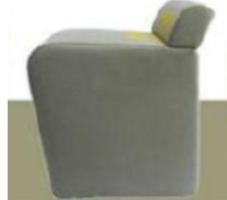
شكل (22) المقعد الروبوتي الذي يتبع المستخدم
