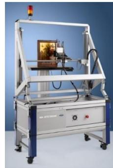
شكل رقم (3): الأشعة السينية الكلية MA-XRF
